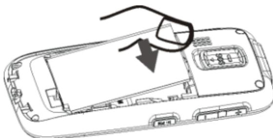
Batteriefachdeckel wieder auflegen bis er mit einem hörbaren "Klickgeräusch" einrastet.
