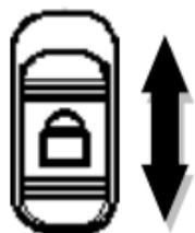
Schieben Sie den Regler der sich auf der linken Seite des Telefon befindet nach oben, so ist die Tastensperre aktiv, nach unten ist die Tastensperre deaktiviert.
