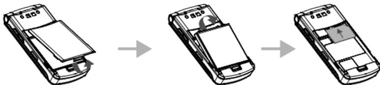
4. Richten Sie die Oberseite des Akkus mit den Zugehörigen Kerben im Telefon aus und legen Sie die Unterseite des Akkus in das Telefon ein und schieben Sie die Oberseite des Akkus nach unten wie in der Abbildung beschrieben ein. Setzen Sie den Akkufachdeckel wieder ein.
