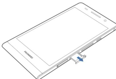
3. Setzen Sie die microSD™-Karte entsprechend der auf der Karte angegebenen Richtung in den Halter ein und schieben Sie den Halter wieder an seinen Platz.
