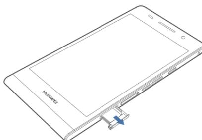
3. Setzen Sie die Micro-SIM-Karte entsprechend der auf der Karte angegebenen Richtung in den Halter ein und schieben Sie den Halter vorsichtig wieder an seinen Platz.
