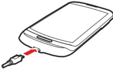
1. Verbinden Sie das zu Ihrem Mobiltelefon gehörende USB-Kabel mit dem Ladegerät.
