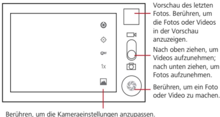
Drücken Sie auf dem Bildschirm für Bildaufnahmen, um das Bedienfeld für die Bildaufnahme zu öffnen.
