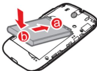
1. Setzen Sie zuerst die mit **a** markierte Seite des Akkus (mit den Kontakten) in den oberen Bereich des Akkusteckplatzes ein.
