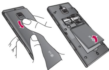
**⚠️ WARNUNG:** Entfernen Sie den Akku nicht, während das Telefon eingeschaltet ist. Dies könnte Schäden am Telefon zur Folge haben.
