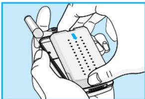
1. Setzen Sie den Akku auf der Rückseite des Telefons ein.
