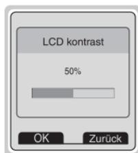
Der Farbkontrast des Displays kann durch Drücken von ◀%, ▶ eingestellt werden.
