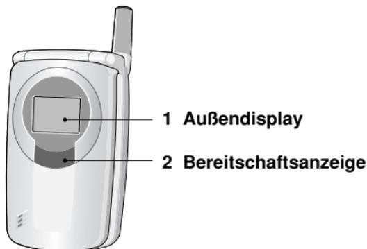
Das Symbol für eine erhaltene SMS oder Sprach-Nachricht wird auch bei zugeklapptem Gerät angezeigt. Auf dem Außendisplay können Sie bei ein- und ausgehenden Anrufen den Namen und die Nummern überprüfen.
