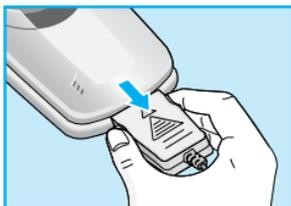
Entfernen Sie das Ladekabel vom Mobiltelefon durch gleichzeitiges Drücken der beiden seitlichen Tasten am Anschlussstecker.
