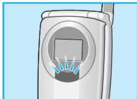
Über die Bereitschaftsanzeige können Sie die Netzverfügbarkeit feststellen. Wenn ein Telefonnetz verfügbar ist, leuchtet die Bereitschaftsanzeige grün. Wenn dagegen kein Netz verfügbar ist, leuchtet diese Anzeige rot.
