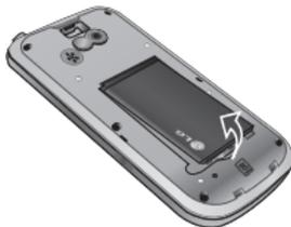
**⚠️ WARNUNG:** Entfernen Sie den Akku nicht, während das Telefon eingeschaltet ist. Dies könnte Schäden am Telefon zur Folge haben.
