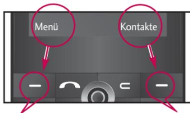
Drücken Sie die linke Funktionstaste um auf das verfügbare Menü zuzugreifen.
