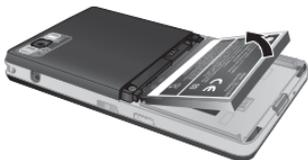
**Das Entnehmen des Akkus bei eingeschaltetem Gerät kann zu Fehlfunktionen führen.**
