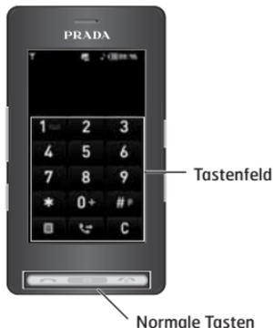
2. Normalerweise genügt ein leichter Druck auf die Sensortasten, um das Mobiltelefon zu bedienen.
