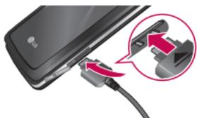
1. Vergewissern Sie sich, dass sich der Akku ordnungsgemäß im Telefon befindet. Verbinden Sie dann das Kabel des Ladegeräts mit dem rechten Anschluss am Telefon. Achten Sie darauf, dass der Pfeil auf dem Stecker nach vorn zeigt.
