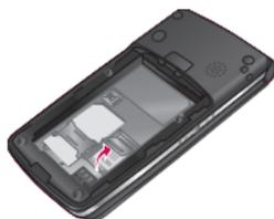
3. Führen Sie die Speicherkarte in den Steckplatz ein. Die Goldkontakte der microSD-Karte müssen zur Rückseite des Telefons weisen. Tritt ein Widerstand auf, stellen Sie sicher, dass Sie die Karte in der richtigen Ausrichtung einführen und dass der Steckplatz nicht durch Fremdkörper blockiert ist.
