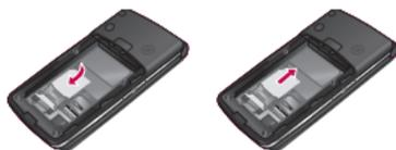
Einsetzen der SIM-Karte Entnehmen der SIM-Karte
