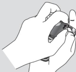
**⚠️ WARNUNG:** Entfernen Sie den Akku nicht, während das Telefon eingeschaltet ist. Dies könnte Schäden am Telefon zur Folge haben.
