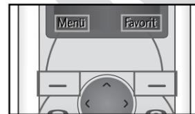
Drücken Sie die linke Funktionstaste um auf das verfügbare Menü zuzugreifen.
