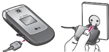
1. Verbinden Sie den Stecker des Ladegeräts in Pfeilrichtungen (siehe Abbildung) mit dem Anschluss an der Unterseite des Telefons, bis er hörbar einrastet.
