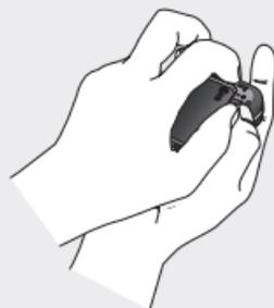
**! WARNUNG:** Entfernen Sie den Akku nicht, während das Telefon eingeschaltet ist. Dies könnte Schäden am Telefon zur Folge haben.
