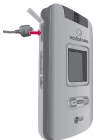
1. Verbinden Sie den Stecker des Ladegeräts mit dem Anschluss an der linken Seite des Telefons, bis er hörbar einrastet. Beachten Sie dabei die in der Abbildung angezeigte Pfeilrichtung.
