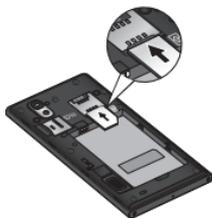
3. Setzen Sie den Akku ein, indem Sie die goldfarbenen Kontakte am Telefon und am Akku zueinander ausrichten (1), und drücken Sie ihn nach unten, bis er einrastet (2).
