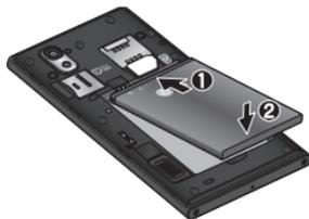
4. Legen Sie die rückseitige Abdeckung auf das Akkufach (1), und drücken Sie sie nach unten, bis sie einrastet (2).
