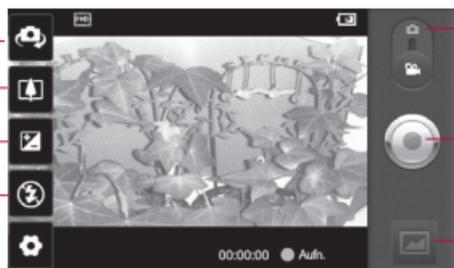
**Kamera-Modus** – Schieben Sie dieses Symbol nach oben, um in den Kameramodus zu wechseln.
