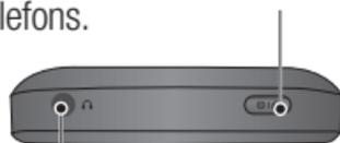
Anschluss für Freisprechanlage oder Stereo-Kopfhörer
