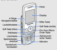
Die Telefonrückseite verfügt über folgende Tasten und Funktionen:
