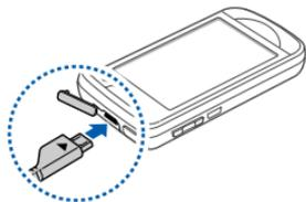
2 Stecken Sie das kleine Ende des Reiseadapters in das Gerät.
