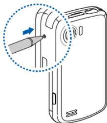
Wenn das Gerät nicht mehr reagiert oder "hängt", kann es erforderlich sein, Programme zu schließen oder das Gerät zurückzusetzen, damit es wieder funktioniert. Wenn das Gerät noch arbeitet, aber ein Programm nicht mehr reagiert, schließen Sie das Programm mit dem Task-Switcher.
