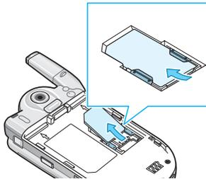
4. Setzen Sie den Akku wieder auf. Achten Sie darauf, die Laschen am Akku in die entsprechenden Schlitze am Telefon einzuführen.
