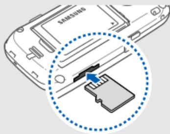
3. Schieben Sie die Speicherkarte in den Speicherkarteneinschub, bis sie einrastet.
