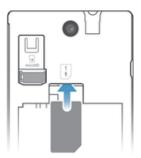
Nehmen Sie die Akkuabdeckung ab und setzen Sie dann die SIM-Karte mit den goldfarbenen Kontakten nach unten in das Kartenfach ein.
