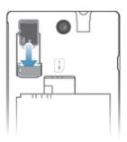
• Nehmen Sie die Akkuabdeckung ab und setzen Sie die Speicherkarte mit den goldfarbenen Kontakten nach unten ein.
