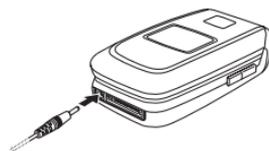
Le temps de charge varie selon le chargeur et la pile utilisés. Par exemple, la recharge d'une pile BL-4C avec un chargeur AC-3 prend environ 2 heures et 12 minutes lorsque le téléphone est en mode veille.
