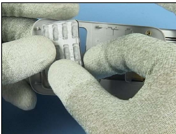
16. Remove the NUMERIC KEYMAT.
