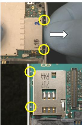
**NOTE:** THE TWO SNAPS SHOULD REST AGAINST ITS **SIM** CONNECTOR SIDE OF THE CIRCUIT BOARD.
