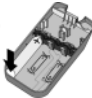
Der Plus-/Minuspol ist am Boden des Fachs markiert
