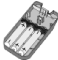
Der Plus-/Minuspol ist am Boden des Fachs markiert
