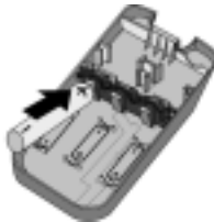
Der Plus-/Minuspol ist am Boden des Fachs markiert
