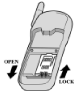
Einschieben und verriegeln
