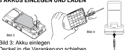
Bild 4 & 5: Zum Laden den Stecker des Ladekabels in die Buchse auf der Unterseite des Gerätes (Bild 4) oder in die Buchse auf der Rückseite des Tischladers (Bild 5, nur C115)
