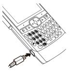
enchufarlo a la toma de corriente de la pared. En el teléfono aparece un icono de batería cargada o **Carga completa** cuando termina.
