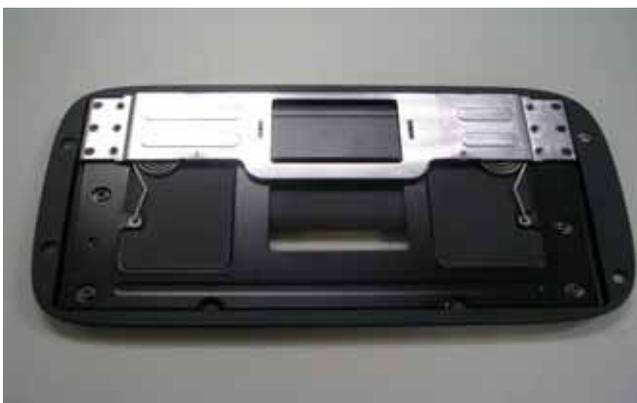
Disassemble display bottom COVER
