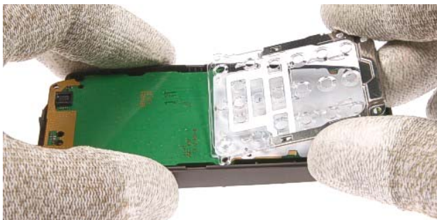
15.) Remove the Light Guide Assy .
