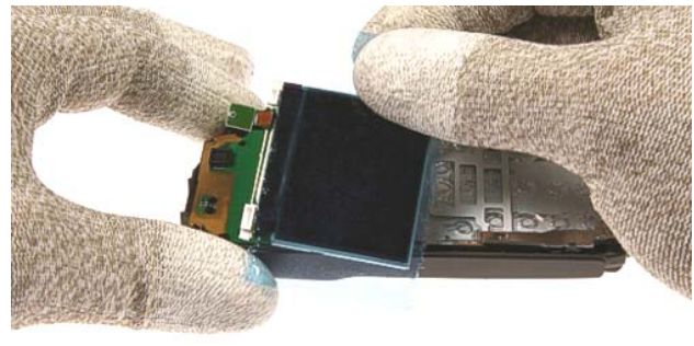
14.) Remove the LCD Module .
