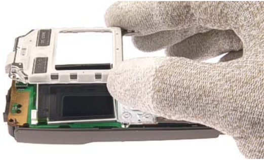
9.) Remove the LCD Shielding .
