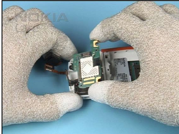
20. Remove the PWB MODULE.
