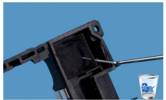
36. Remove **IHF FRONT GASKET** if necessary.
