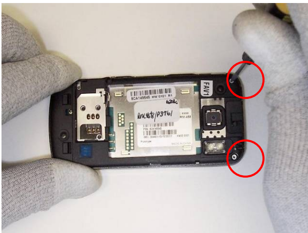
7) Remove 2ea. #4 TORX screws
