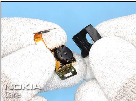
19. The CAMERA GASKET can be removed.
