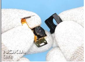
19. The CAMERA GASKET can be removed.
