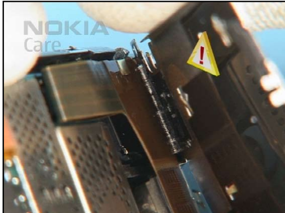
20. ...and very carefully separate the DISPLAY BACK PLATE from the AV FLEX.
