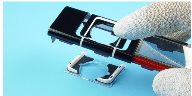
8.) The Keymat drops out when turning the A-Cover .
