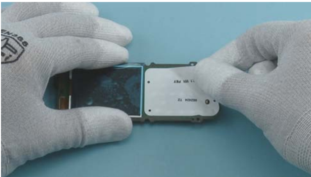
31) Peel off the DOMESHEET.
