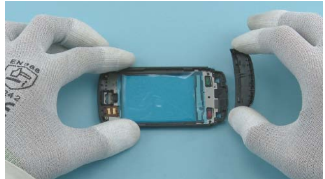
32) Remove the A-COVER DECO.
