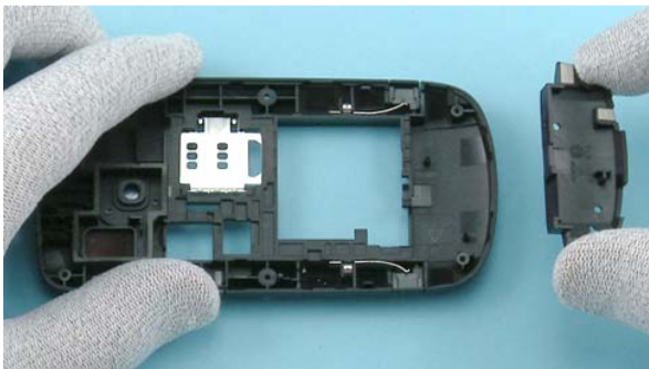
29) Remove the ANTENNA MODULE ASSY.
