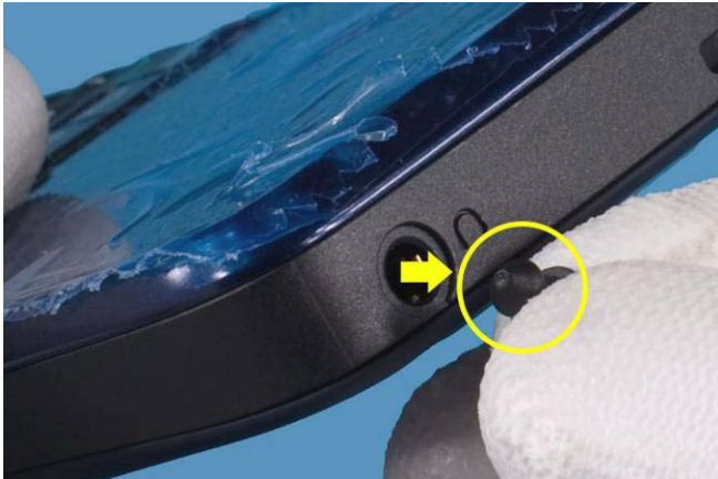
1) Pull out AV DOOR with fingers.
