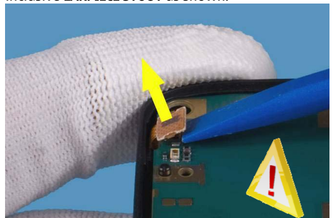
18) Disconnect the AV FLEX with SS-93 tool.
