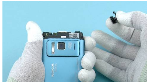
26) Remove the COMBO ANTENNA.
