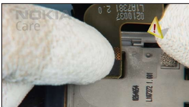
35. Close the UI MODULE connector.
