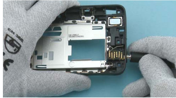
20) Release the AV connector with the AV plug and remove the connector.
