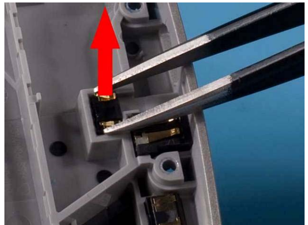
48) Use tweezers to remove MICROPHONE .
