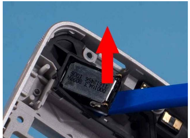
46) Use SS-93 tool to lift up IHF SPEAKER .
