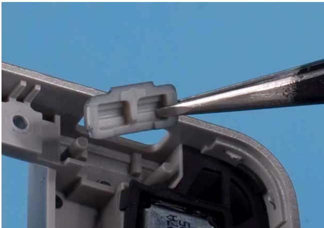
45) Use tweezers to remove SHUTTER KEY .
