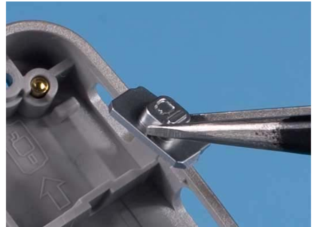
34) Use tweezers to remove HOLD KEY .
