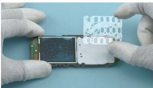
23) Remove the LIGHT GUIDE.
