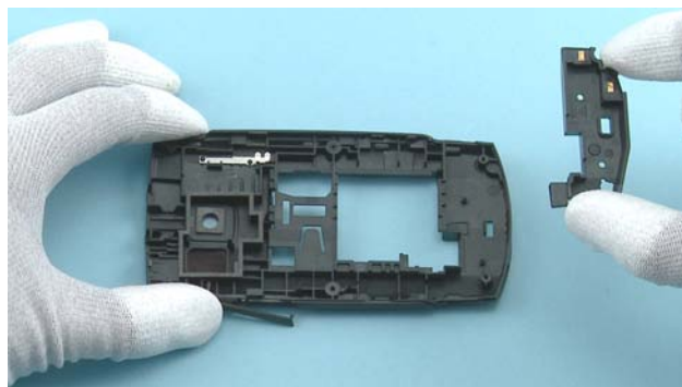
30) Remove the ANTENNA MODULE.
