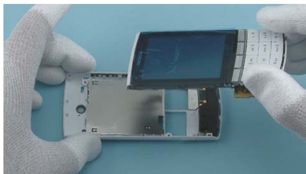
14) Separate the B-COVER.
